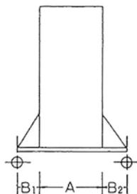
ローリングタワーは、作業床、これを支持する枠組構造、脚輪ならびに梯子などの昇降設備および手摺などの防護設備を備えたものでなければなりません。
