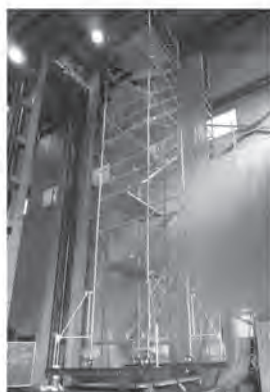
ローリングタワー使用時の安定性検証 傾斜実大実験
