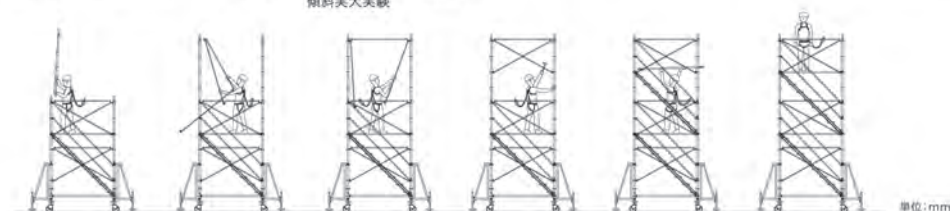
ローリングタワー使用時の安定性検証 傾斜実大実験
