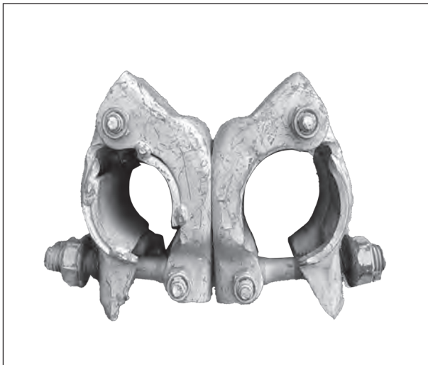
●スーパークランプ兼用×36自在 重量：1.80kg 許容荷重：900kg
