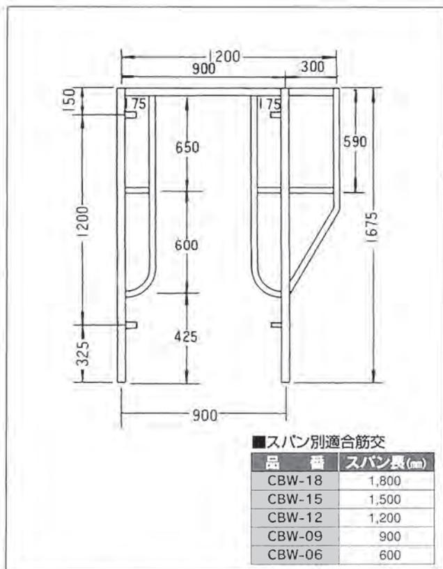
●ブラケット枠(拡幅枠)0617
