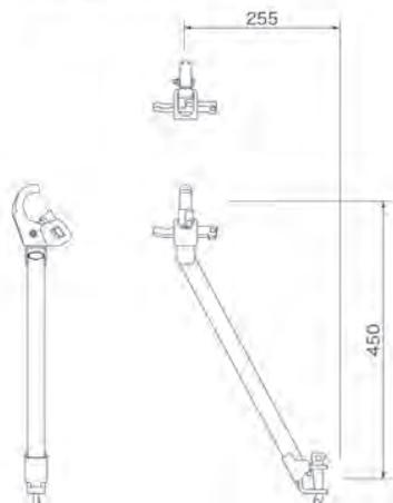
通常の布材に後から取り付け可能、床付き布枠の掛かった状態でも簡単に取り付けられます。
