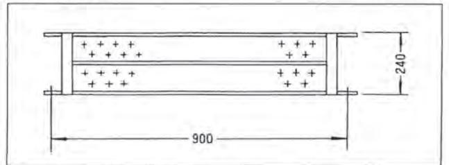
●鋼製布枠 5060 重量:6.11kg
