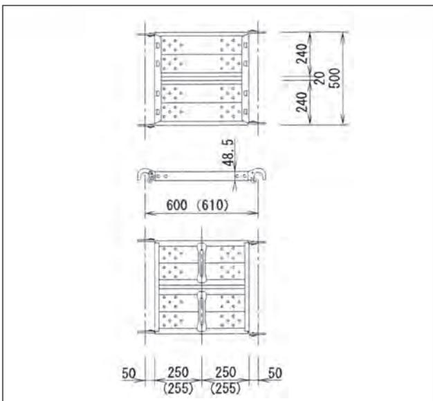
●鋼製布枠 2060 重量:3.72kg
