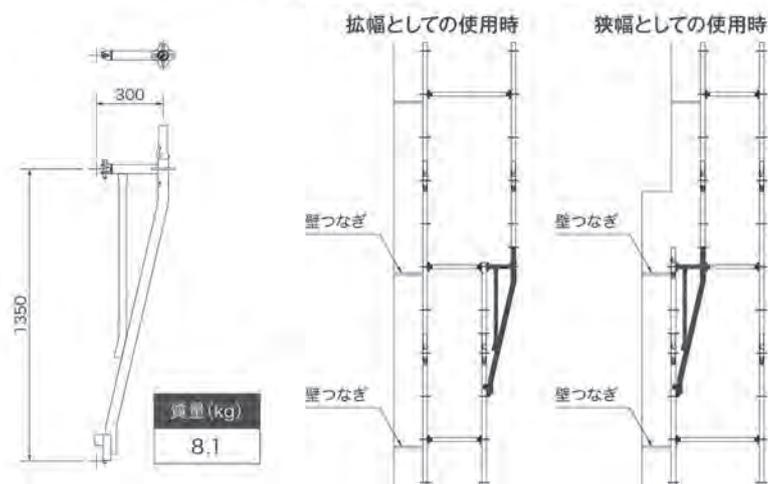
拡幅狭幅兼用ブラケットは独自の発想により1種類で拡幅と狭幅のどちらにも使用可能。
