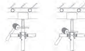
**べた支柱式支保工 33.5kN仕様 (X構面・Y構面とも先行手すり)の設置例**
