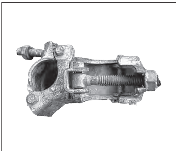
●スーパークランプ兼用×60直交 重量：1.62kg 許容荷重：900kg
